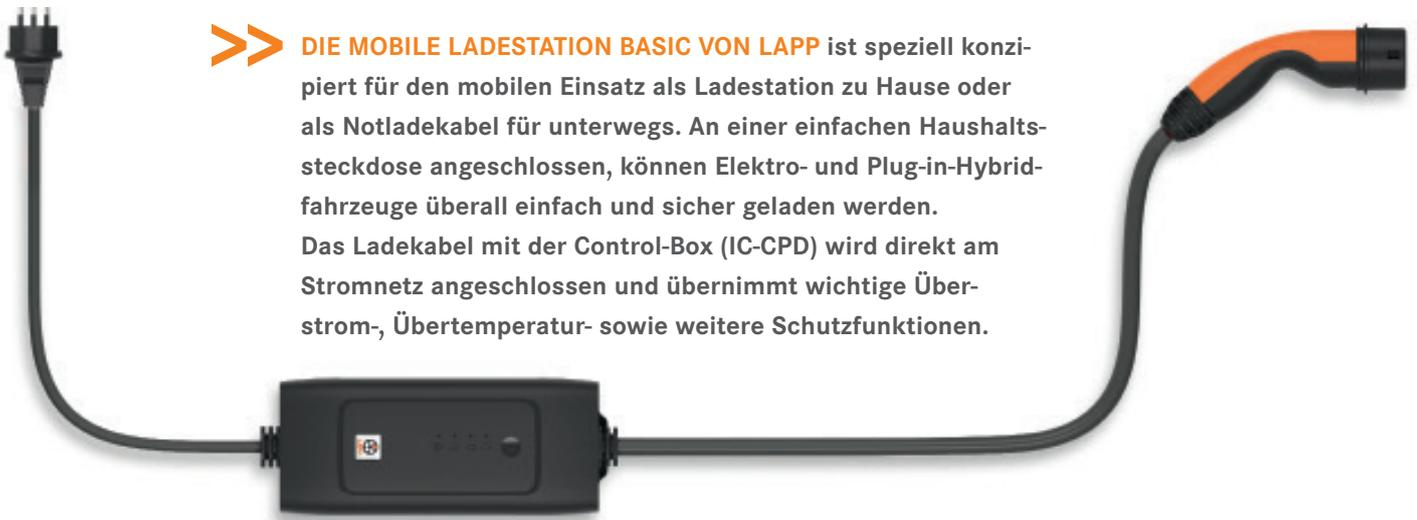
**>>> DIE MOBILE LADESTATION BASIC VON LAPP** ist speziell konzipiert für den mobilen Einsatz als Ladestation zu Hause oder als Notladekabel für unterwegs. An einer einfachen Haushaltssteckdose angeschlossen, können Elektro- und Plug-in-Hybridfahrzeuge überall einfach und sicher geladen werden. Das Ladekabel mit der Control-Box (IC-CPD) wird direkt am Stromnetz angeschlossen und übernimmt wichtige Überstrom-, Übertemperatur- sowie weitere Schutzfunktionen.
